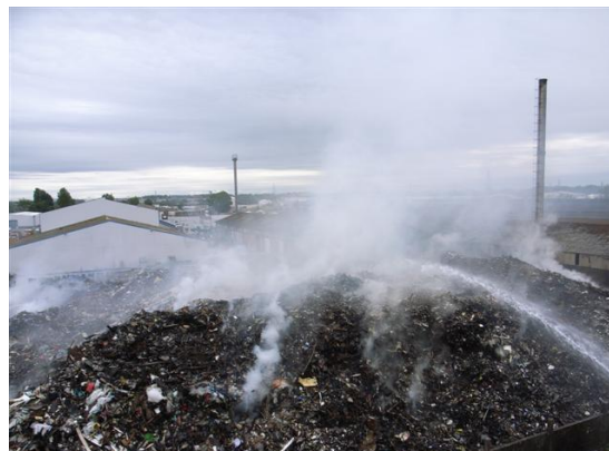
Feu couvant suite à l'auto-échauffement de déchets
