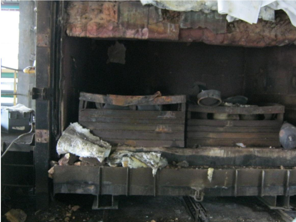
Explosion dans le four à cuivre d'un incinérateur de déchets dangereux (ARIA 45127)
